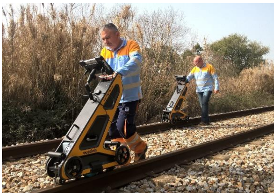
Inspeção em Contínuo c/ Equip. Portáteis
