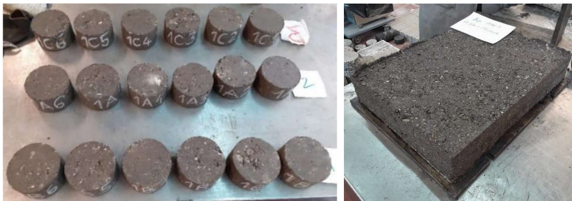
Figura 4. Provetes Marshall (esquerda) e lajeta (direita) de mistura reciclada a frio produzidas em laboratório durante o estudo de formulação
