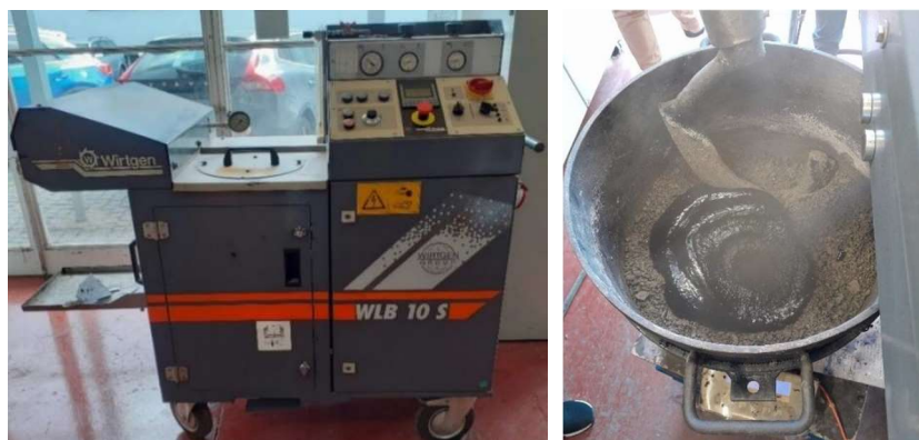
Figura 3. Equipamento Wirtgen WLB10S (esquerda) e betume-espuma produzido (direita)
