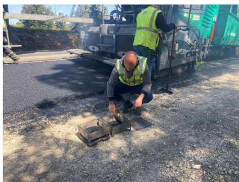
Figura 14. Recolha de amostras (esquerda) e preparação para posterior recolha de lajes (direita)
