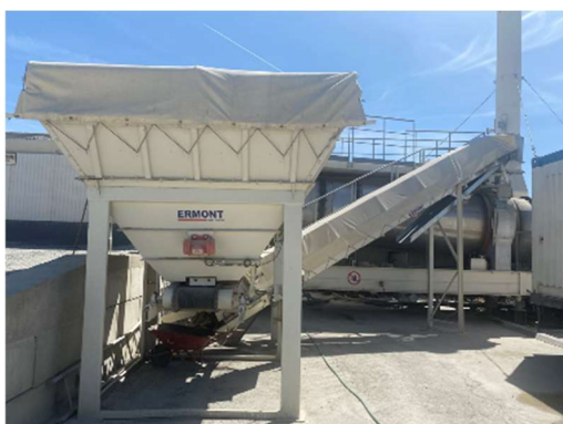
Figura 11. Silo alimentador/doseador (esquerda) e comando do variador (direita)
