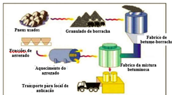
Figura 1. Sequência do processo por via húmida (adaptado de [1])
