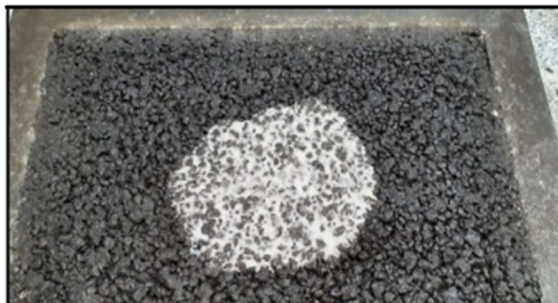
Figura 8. Provete para ensaio de mancha de areia [6]
